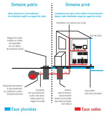
La jonction avec les canalisations posées à l'intérieur des propriétés privées doit assurer une parfaite étanchéité et est réalisée sous le contrôle du Service Public de l'Assainissement.
